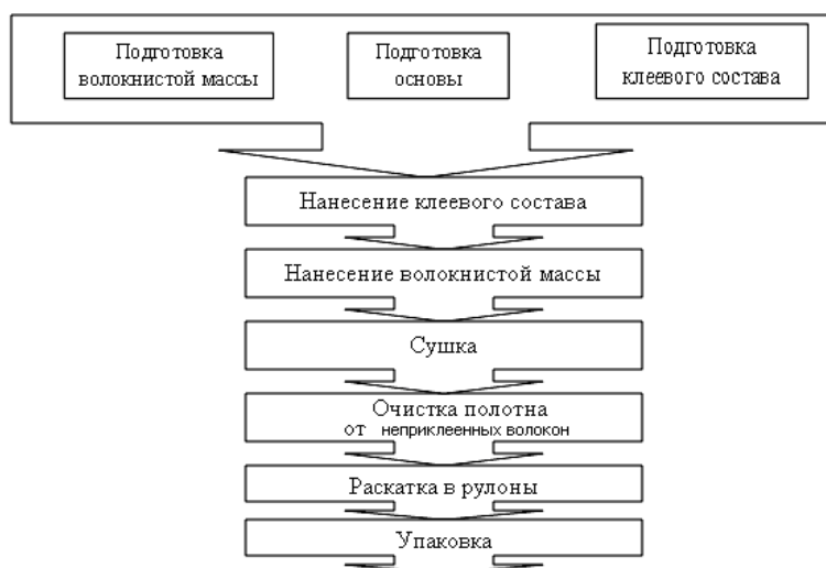
Рисунок 1 – Схема технологического процесса изготовления композиционных текстильных материалов
