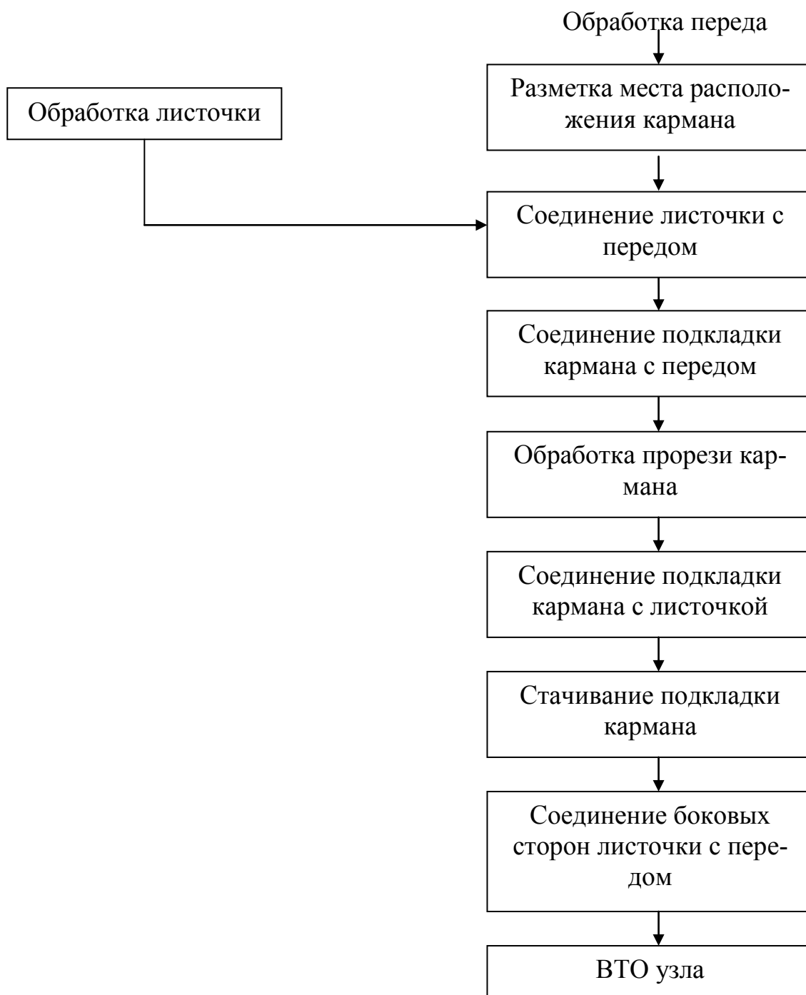
Рисунок 2.1 – Блок-схема обработки верхнего прорезного кармана с листочкой
