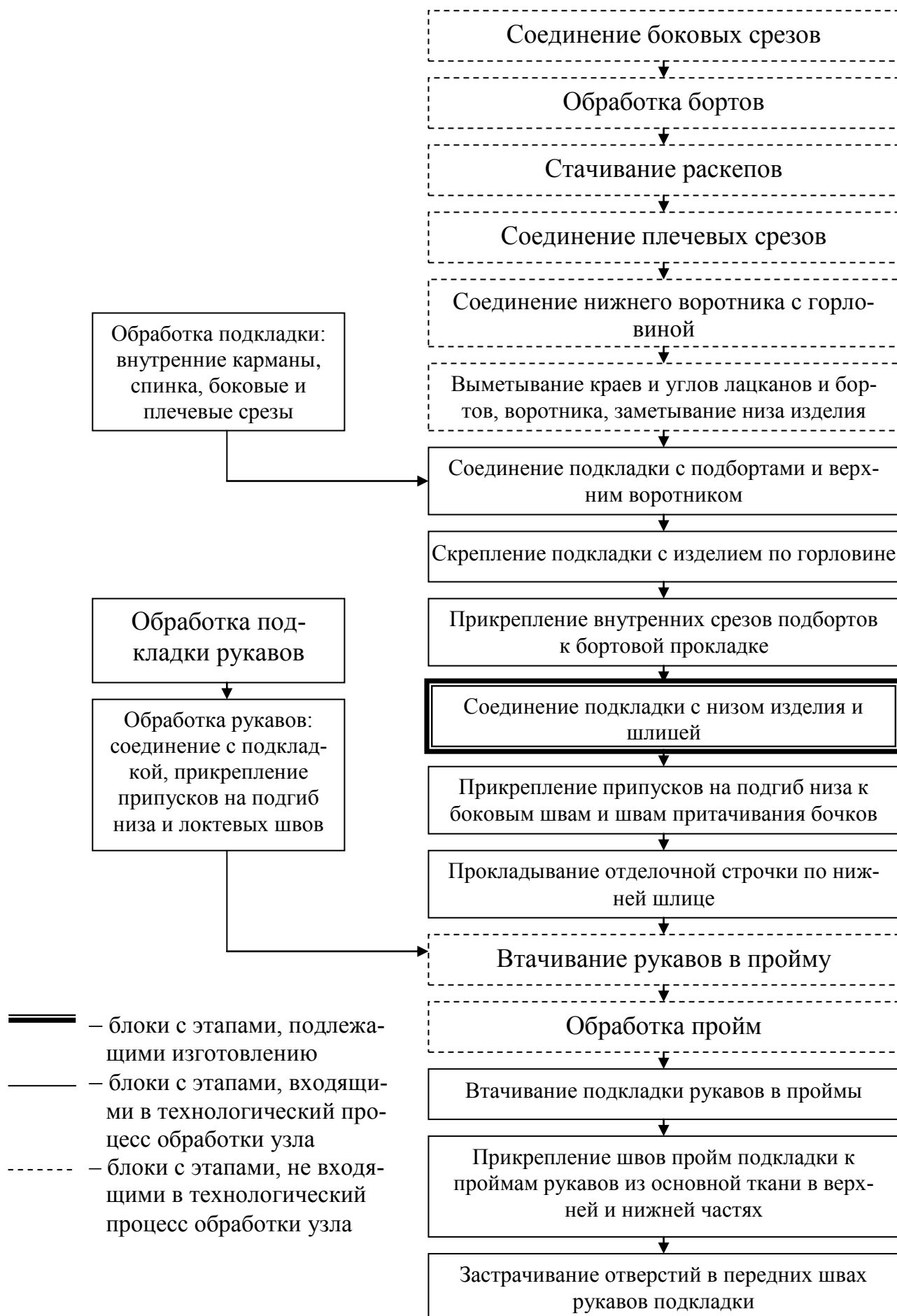
Рисунок 11.1 – Блок-схема соединения подкладки с мужским пиджаком
