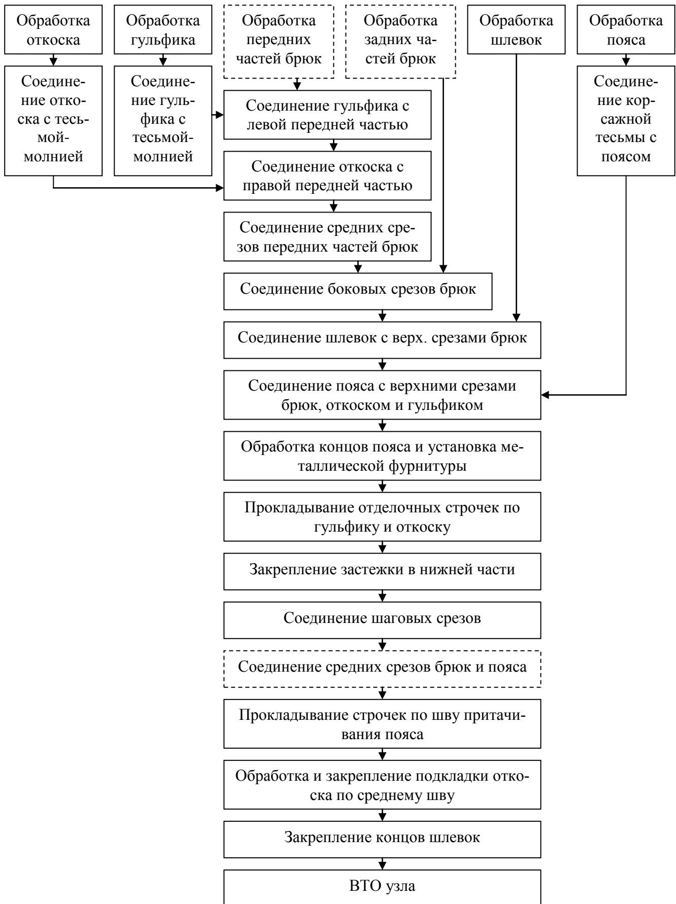
Рисунок 12.1 – Блок-схема обработки верхних краев брюк с застежкой на тесьму-молнию
