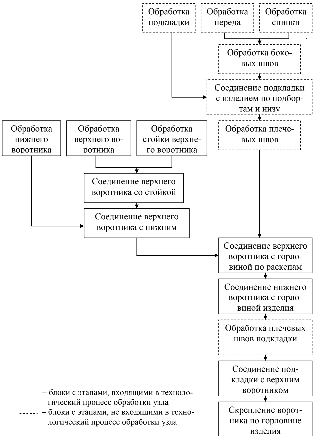
Рисунок 8.1 – Блок-схема обработки воротника мужского пиджака с отрезной стойкой и соединения его с горловиной изделия
